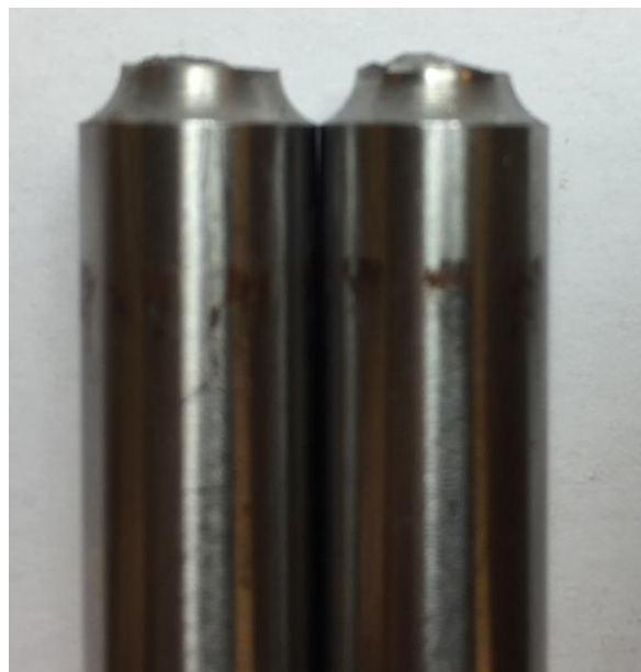
Figura 77. Vista de rotura de dos probetas
