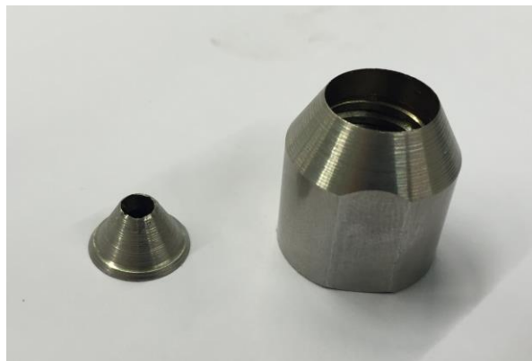
Figura 80. Rotura del segundo modelo de cabezal
