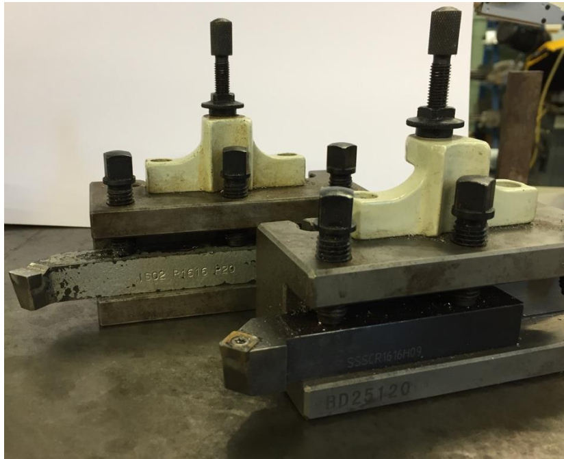
Figura 35. Ejemplo de herramientas comunes de torno
