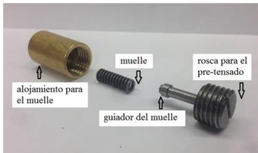
Figura 22. Sistema de pretensado y sujeción
