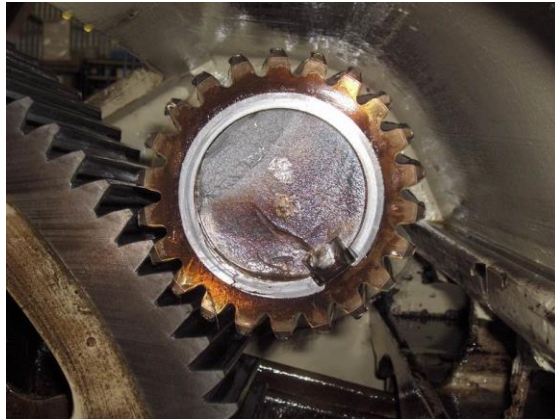
Figura 2. Fallo en un eje por la acción de la fatiga
