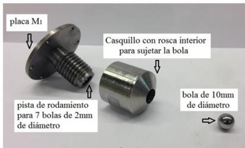
Figura 20. Conjunto de elementos para el bruñido
