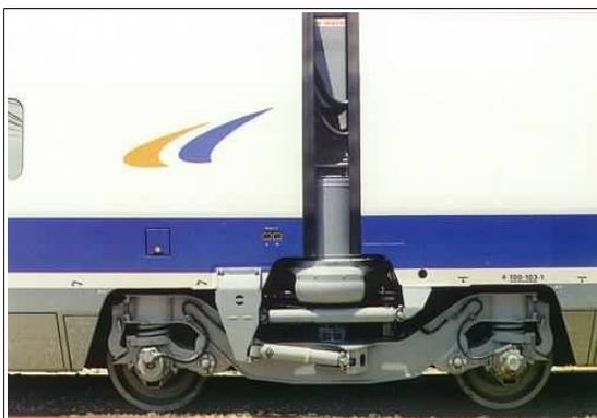
**Figura 4.3. Bogie en unión de coches del Euromed 100-103.**
