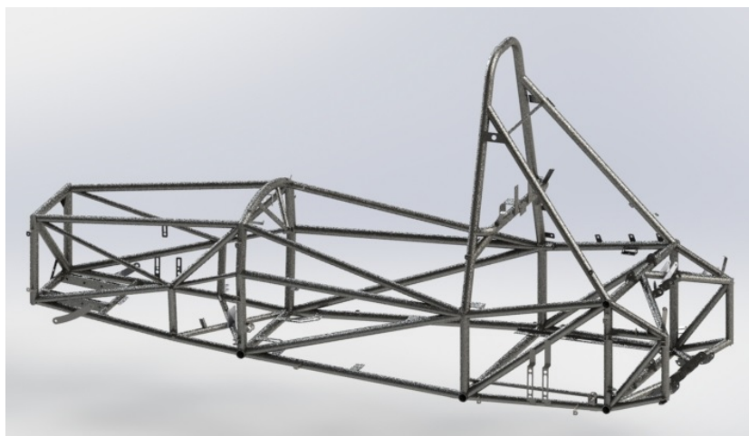
Imagen 2.2 Estructura multitubular del EV-a, Formula Student EUETIB e-Tech Racing
