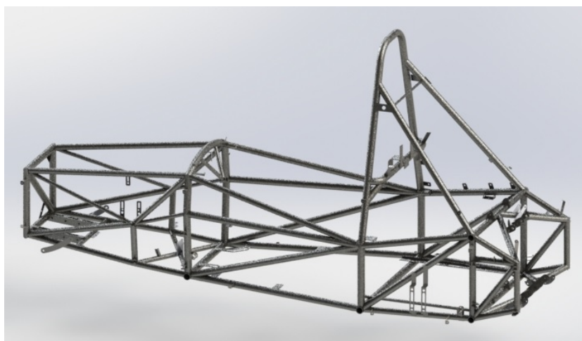
Imagen 6.1 Estructura multitubular del EV-a, Formula Student EUETIB e-Tech Racing
