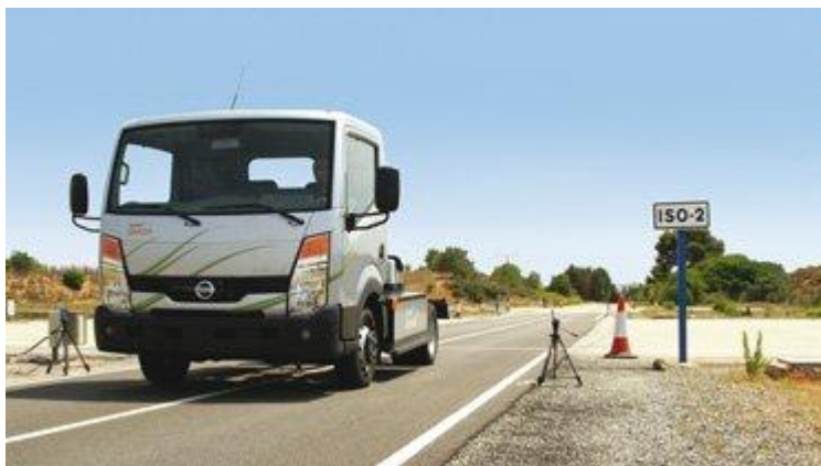
Ilustración 38 Ejemplo de un ensayo de ruido en la pista ISO-2
