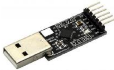
Ilustración 27 USB a UART basado en CP2102
