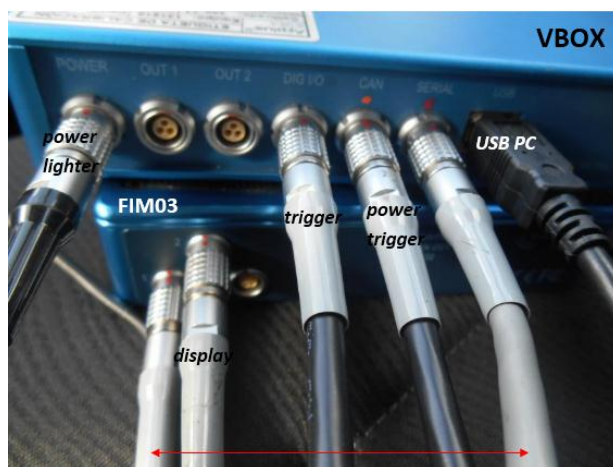
Ilustración 41 Montaje VBOX ensayo 51R03
