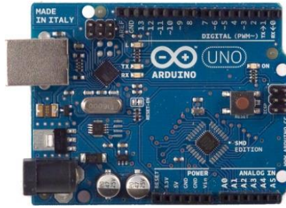
Figure 27. The microcontroller Arduino UNO.
