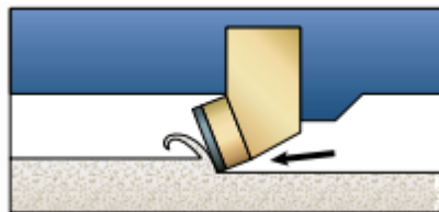
Figura 48: Procés de tall dels compactes d'una barra de PDC
