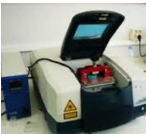
Figura 12: Equipo FTIR 4100 Jasco que opera en modo ATR (reflexión total atenuada).
