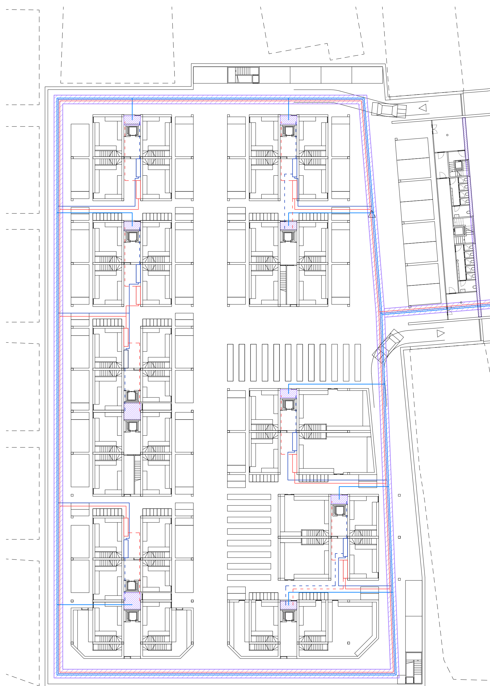
Planta Soterrani E 1/500 Distribució general instal·lacions
