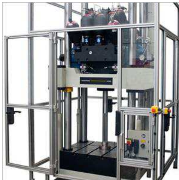
Figura 8. Ejemplo de máquina servohidráulica [6]
