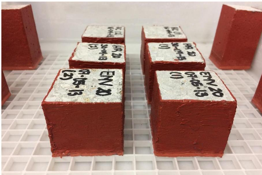
Figura 9. Ensayo de especímenes por succión capilar
