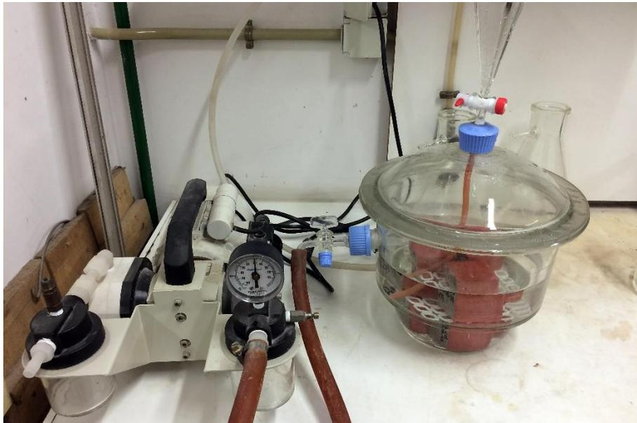
*Figura 10. Saturación de especímenes con bomba de vacío*
