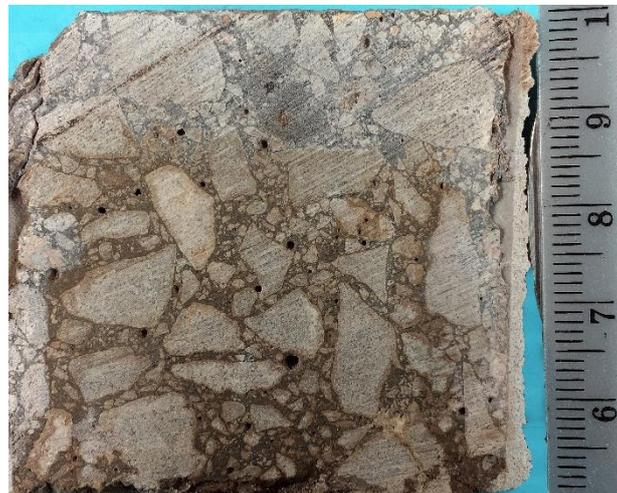
Figura 55. Espécimen del hormigón  $B_{EMV20}$  en la evaluación de penetración de cloruros con  $AgNO_3$
