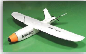
Figura 1. Prototipo Mineos para la detección de minas
