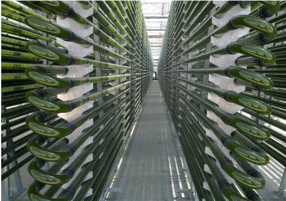
Figura 5.7.5. Ejemplo de FBR cerrado tipo "tubular". (Fuente: Alga energy)
