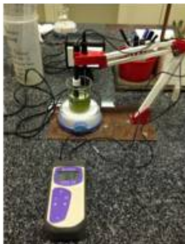
Figura 6.4.2. Medidor de OD utilizado en el laboratorio.
