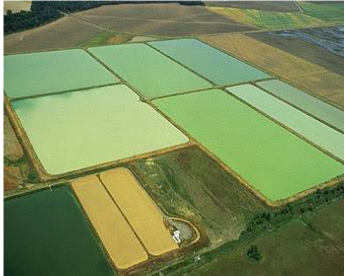
Figura 5.7.1. Ejemplo de FBR abierto tipo “ open ponds ” (Fuente: Piñon Engranado Blogspot)
