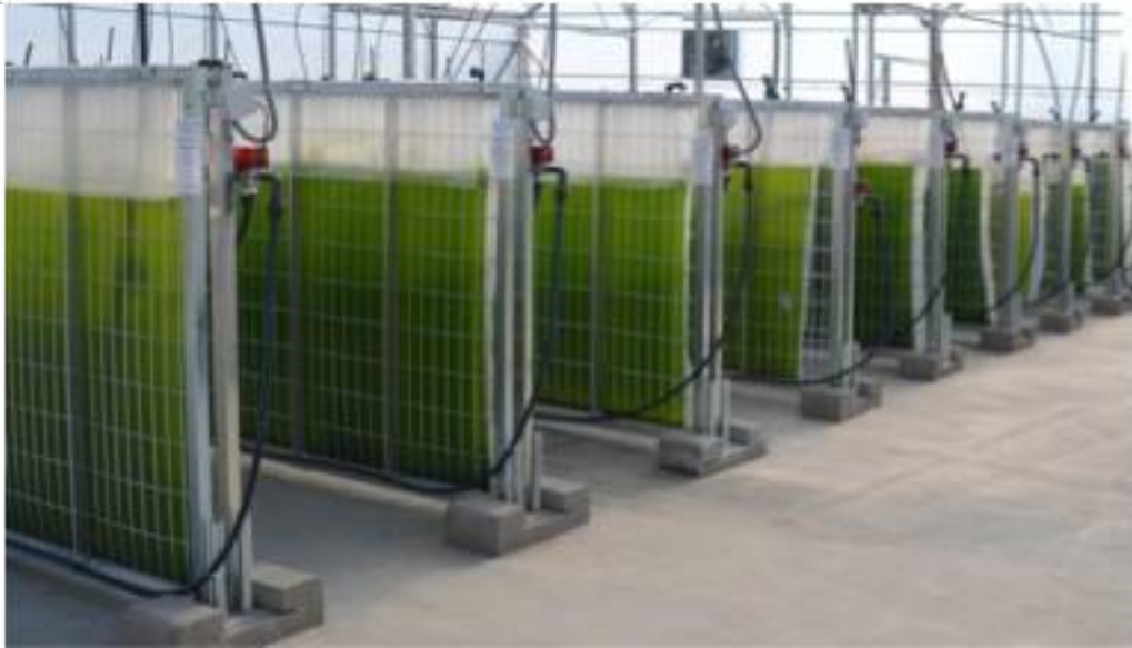
Figura 5.7.4. Ejemplo de FBR cerrado tipo plano. (Fuente: Alga energy)
