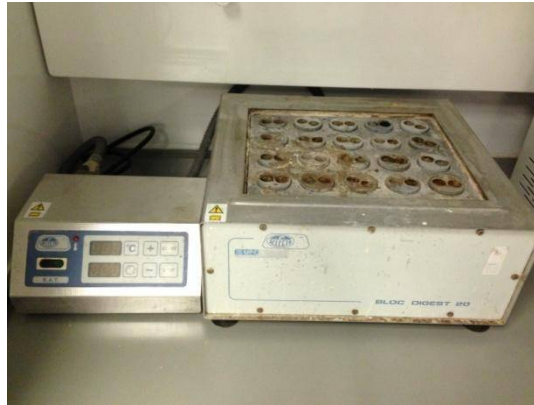
Figura 6.4.13. Termoreactor utilizado para la DQO en el laboratorio.
