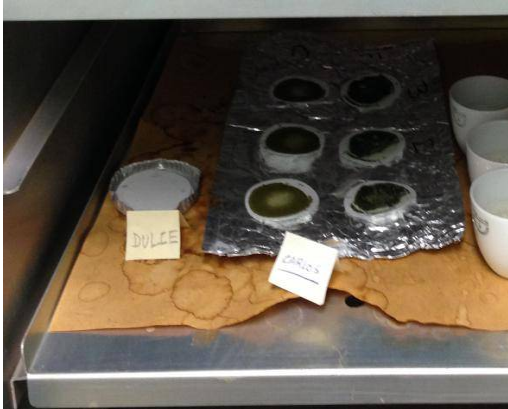
Figuras 6.4.7. y 6.4.8. Filtros con muestra seca y Mufla empleada en laboratorio.
