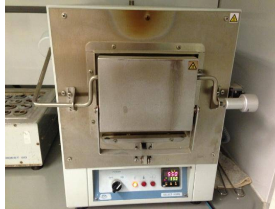
Figuras 6.4.7. y 6.4.8. Filtros con muestra seca y Mufla empleada en laboratorio.
