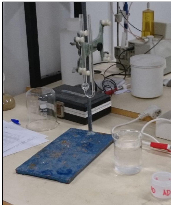
Figura 12. Viscosímetre utilitzat en aquesta tesina.
