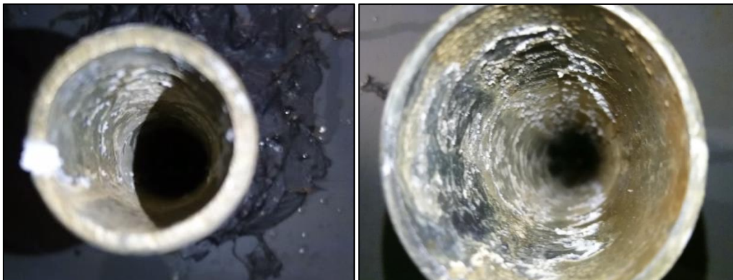
Figura 40. Vista de l'interior del tub prim (esquerra) i del tub gros (dreta) amb cristalls de sal adherits a les seves parets.
