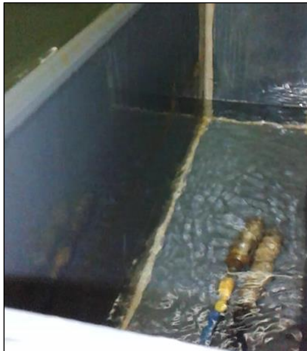
Figura 36. Fluctuacions en la làmina lliure d'aigua del sobreeixidor 2 produïdes pel cabal que aporta el tub gros.
