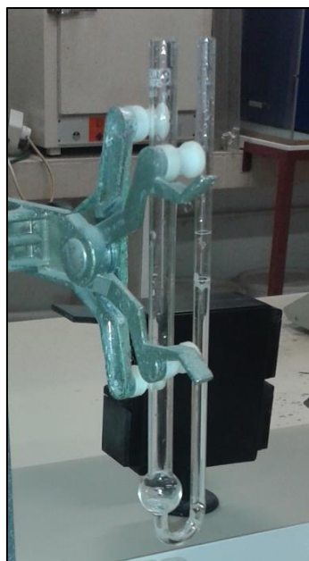
Figura 49. Viscosímetre d'Ostwald usat per a aquests assaigs.
