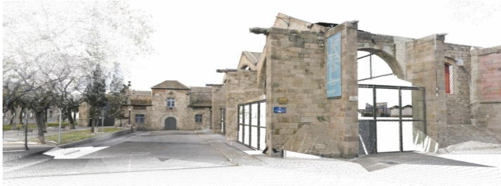
Figura 3. Modelo 3D de alta resolución, elaborado en base a una nube de puntos densa
