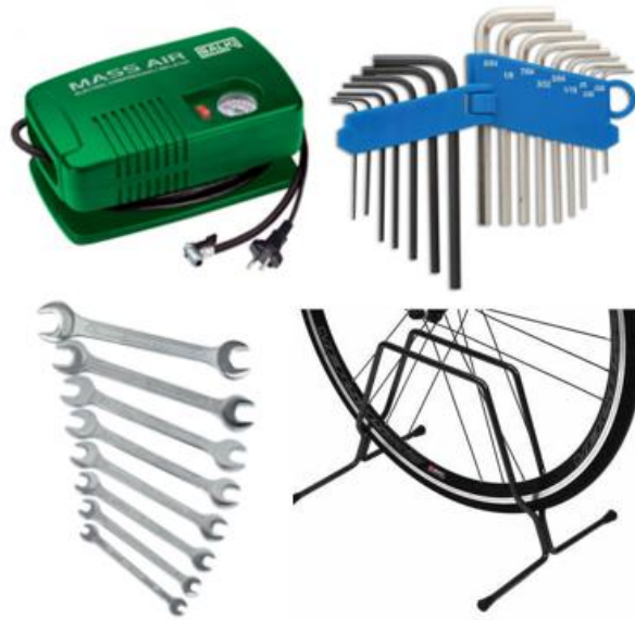
Figura 29: Compresor de aire, juegos de llaves Allen y fijas y soporte para rueda.
