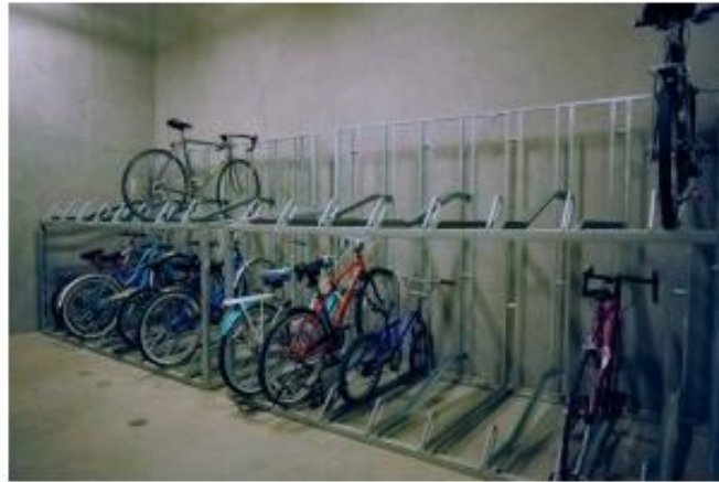
Figura 10: Soporte a doble altura
