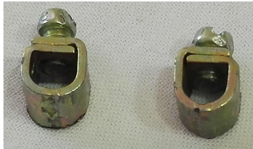
Figura 12. "Adaptacions de la art interior d'una regleta de connexió de 16 mm 2 .
