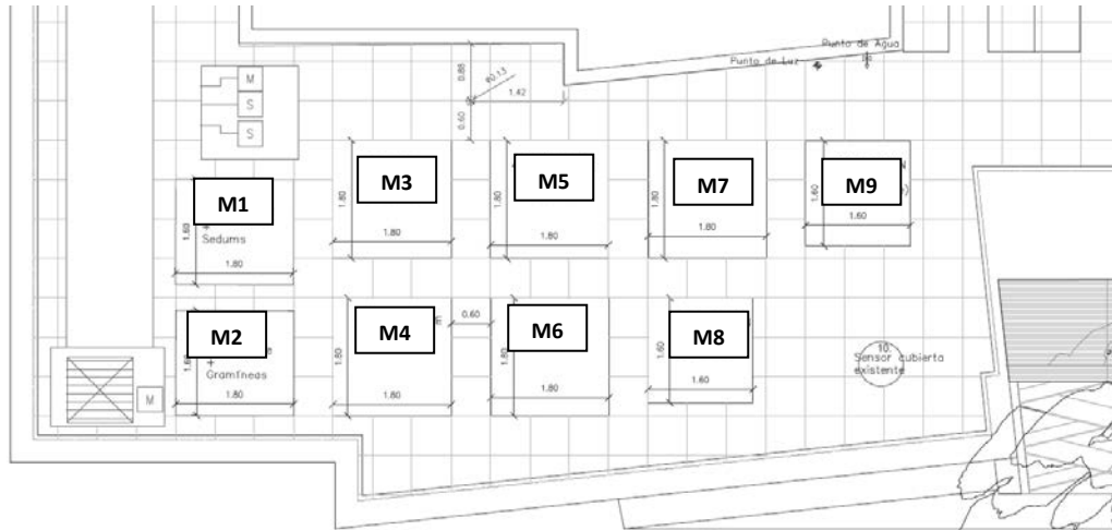
Fig. 1 Distribució dels parterres/jardineres amb cadascuna de les solucions de coberta enjardinada instal·lades
