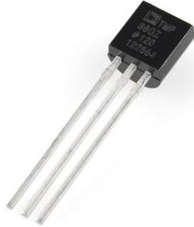
**Fig. 3.5** Sensor de temperatura TMP36
