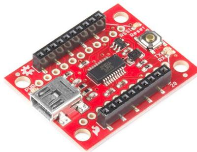
**Fig. 3.6** Dispositivo XBee explorer USB
