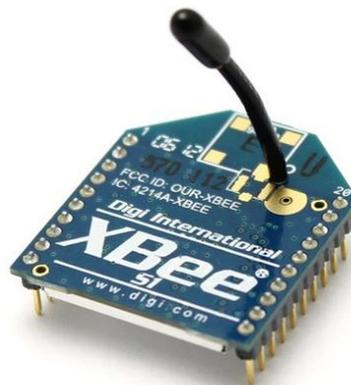
**Fig. 3.2** Dispositivo XBee Series 1
