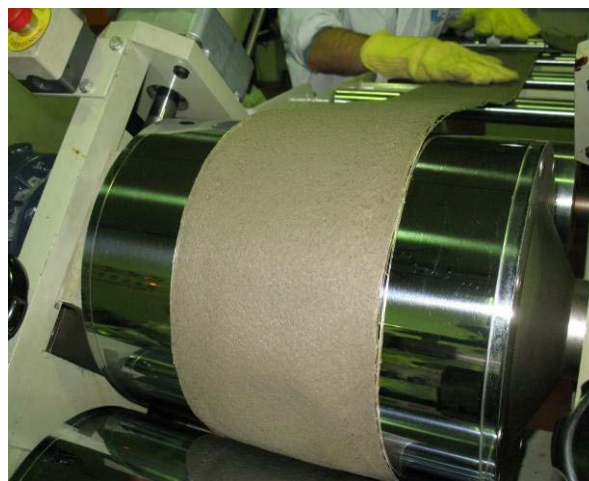
Figura 5: Proceso de extrusi n-calandra del residuo mixto
