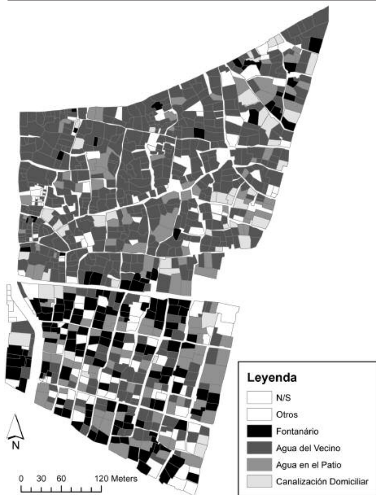
Figura 7 Mapa sobre el tipo de abastecimiento de agua en las zonas 1 y 2 del barrio de Maxaquene 'A' en Maputo, Mozambique
