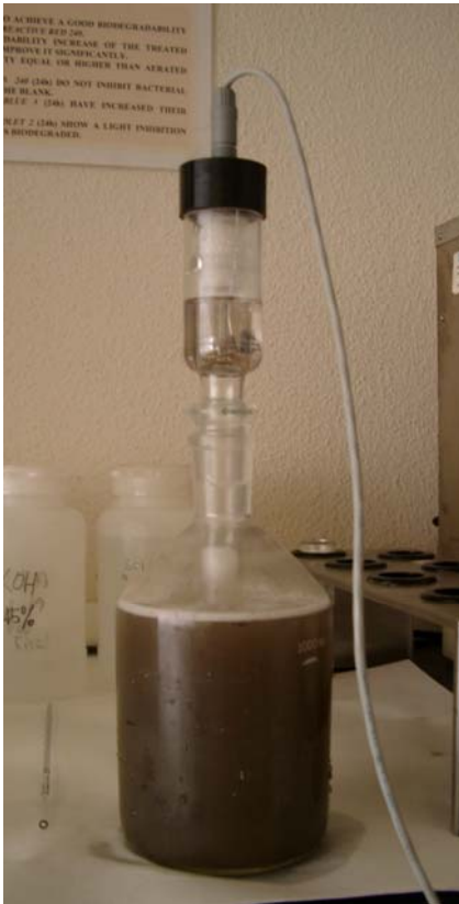
FIGURA 1: Reactor del respirómetro electrolítico
