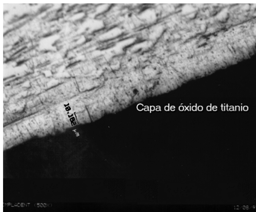
Figura 9. Superficie de titanio donde se aprecia la capa de anodizado.
