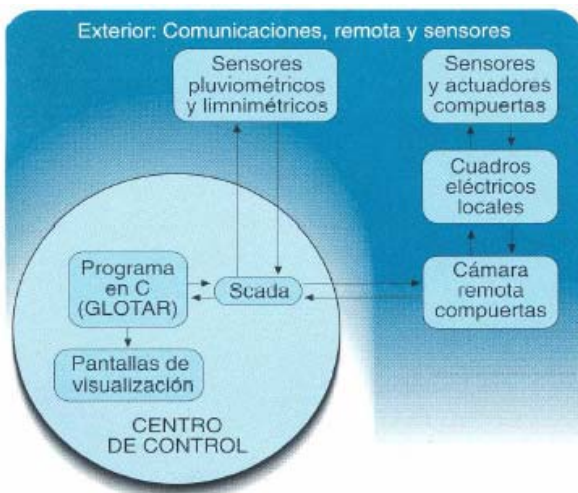
Figura 6. Esquema de la implementación del sistema en el centro de control
