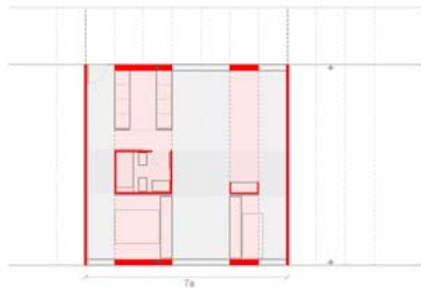
Figura 1. Unidad de vivienda compuesta por agregación de franjas. © ARC Arquitectura i Enginyeria La Salle
