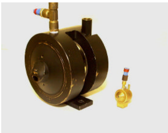
FIGURA 4: Despiece tobera modelo, y comparación con tobera prototipo.
