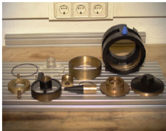
FIGURA 4: Despiece tobera modelo, y comparación con tobera prototipo.
