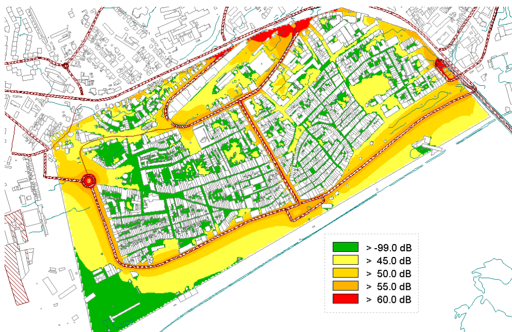
Fig. 4: Cenário 1 - Restrição à circulação de pesados durante o período noturno Ln
