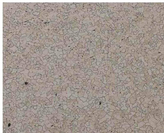
Foto 17. Estructura de grano fino casi exclusivamente ferrítica. (Barra rectangular)
