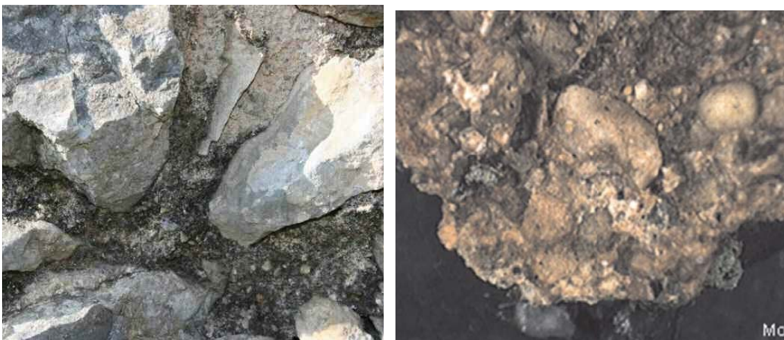
Fotos 10 y 11. Mortero de cal in situ en el paramento y mortero visto con lupa estereoscópica, respectivamente.
