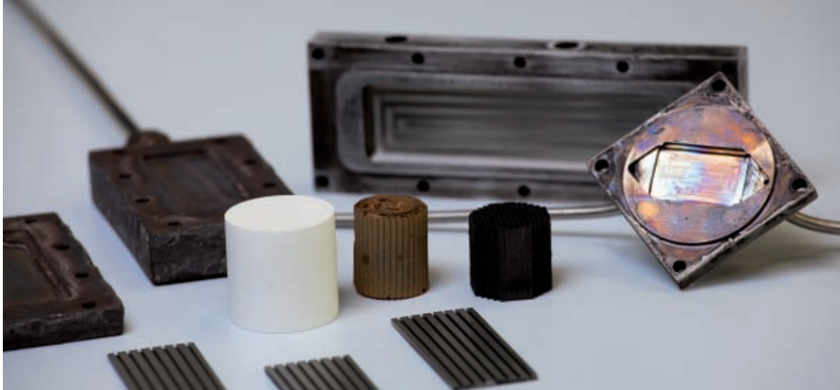
FOTO 2 L'equip de Llorca ha dissenyat catalitzadors i peces de microreactors a l'escala d'aplicacions portàtils.
