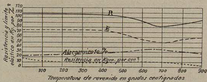
Fig. 9.—Variación de las propiedades de un acero mangano-silicioso templado en aceite a 850° en función de la temperatura de revenido. (Fábricas de la Marina y de Homecourt).
