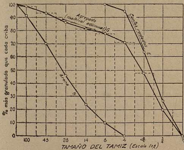
Fig. 2.—GRÁFICO REPRESENTATIVO DE LOS ANÁLISIS AL TAMIZ DEL AGREGADO. Curvas representativas de los análisis al tamiz de los agregados B, E y G del cuadro I.
