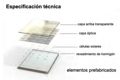
Fig. 4.21 Especificación técnica y esquema de funcionamiento
