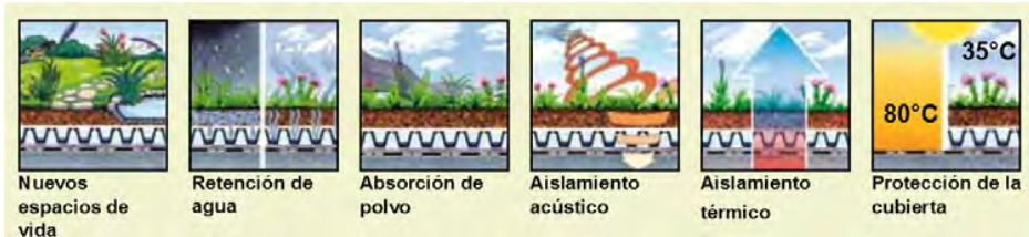
Fig. 2.31 Ventajas de las cubiertas ajardinadas Fuente: ZinCo
