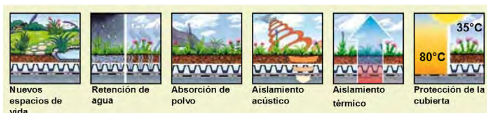
Fig. 1.24 Mejoras medio-ambientales de las cubiertas vegetales. Fuente: ZinCo
