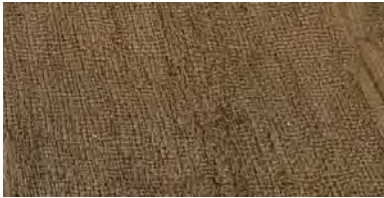
Manta geotextil de protección
