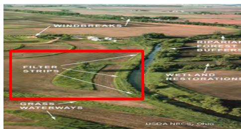
Fig. 1.81 y 1.82 Ejemplo de franjas filtrantes. Fuente: CIRIA
