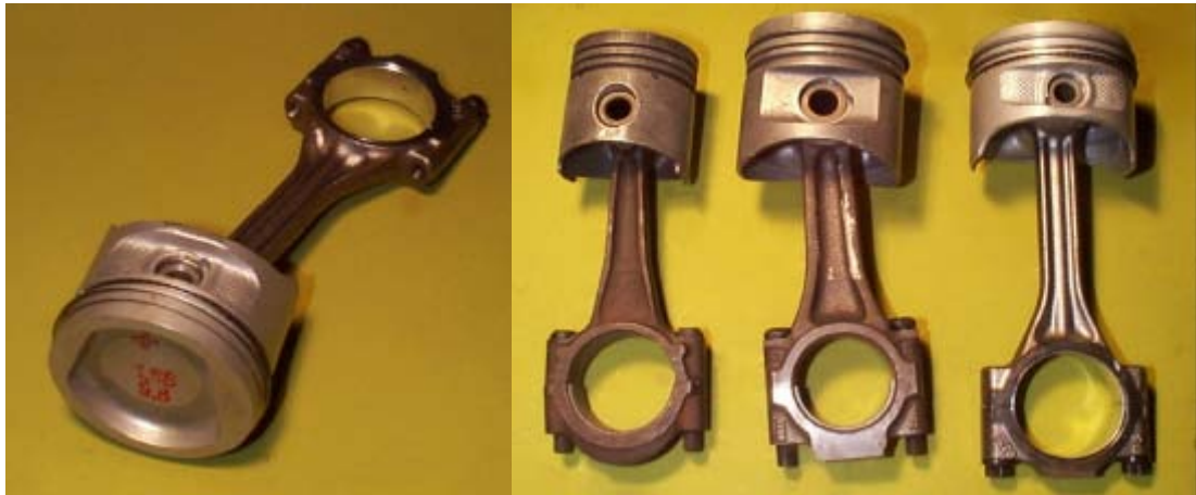
Fig. 3.7 Distintas concepciones de pistones de automoción articulados a sus correspondientes bielas
