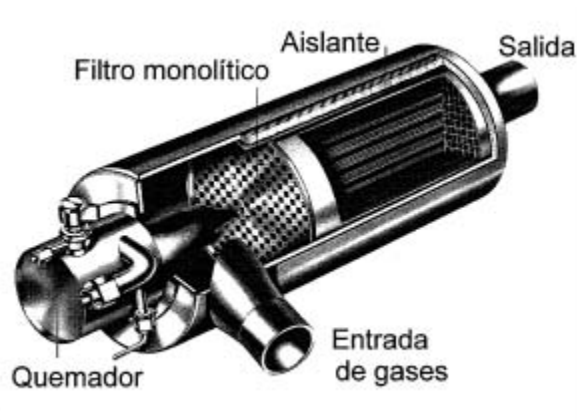
Fig. 11.21 Filtro cerámico de partículas con quemador
