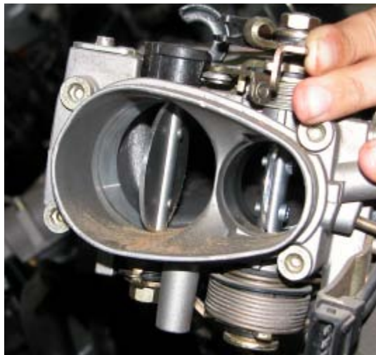
Fig. 7.26 Válvula de mariposa manual de doble cuerpo en posición de abertura a carga total
