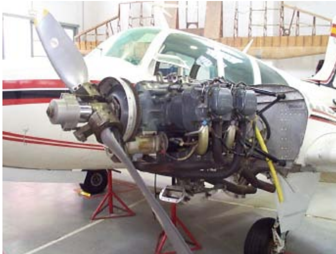
Fig. 3.26 Motor boxer Lycoming para aviación ligera
