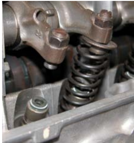
Fig. 13.14 Sistema de ajuste del balancín (en la foto faltan las 2 válvulas y un muelle para dar mejor compresión)
