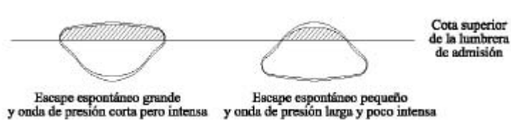
Fig. 9.12 Muestra de diferentes tipologías de lumbreras, que generan diferentes comportamientos en las ondas de presión
