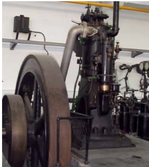
Fig. 3.3 Motor Sulzer estacionario de principios del siglo XX instalado en la escuela de Ingeniería Industrial de Barcelona
