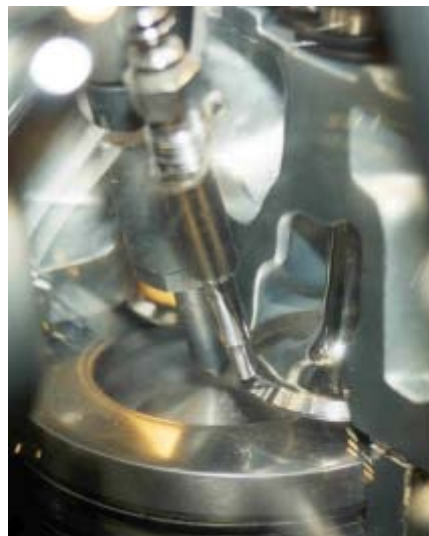
Fig. 3.19 Fotografía de la cámara de combustión de un motor diesel de inyección directa; en primer término la bujía de calentamiento y en segundo término la tobera del inyector
