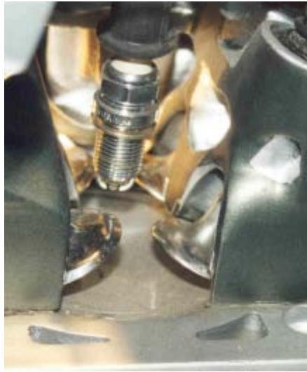
Fig. 3.18 Fotografía de la cámara de combustión de un motor Otto de culata de cuatro válvulas y bujía en posición central
