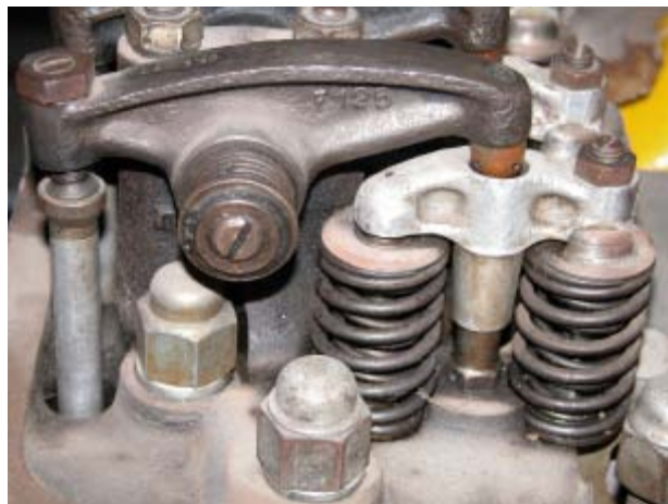
Fig. 13.16 Accionamiento de dos válvulas
