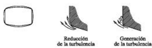
Fig. 9.8 Diseño aerodinámico de las lumbreras para reducir o aumentar la turbulencia del flujo
