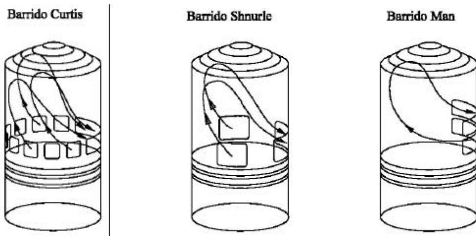
Fig. 9.15 Tipo de barrido por lazo
