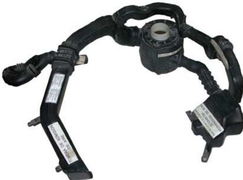
Fig. 7.18 Esquema de la toma de admisión de un motor de encendido provocado con sistema de reducción del ruido de admisión
