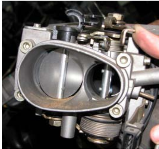
Fig. 7.25 Válvula de mariposa manual de doble cuerpo en posición de abertura a carga parcial
