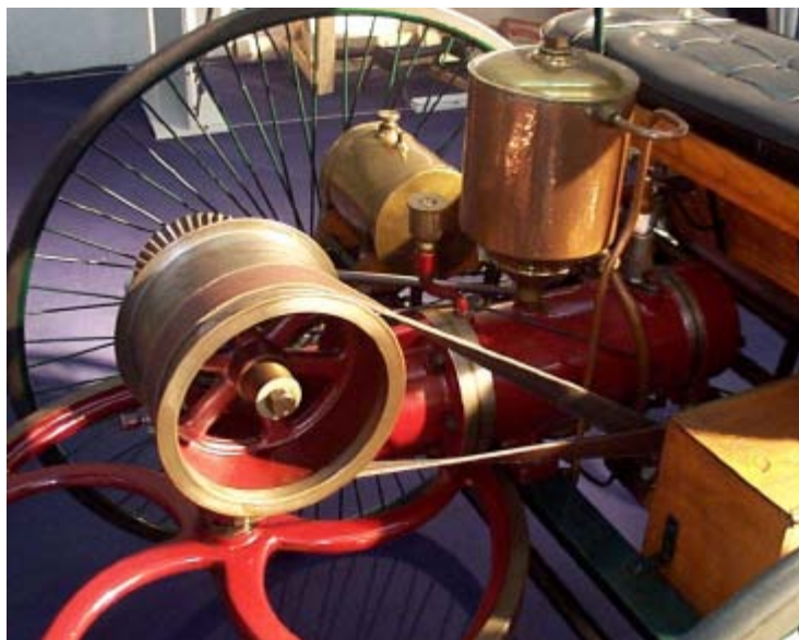
Fig. 3.2 Motor alternativo de combustión interna Daimler de encendido provocado, realizado en 1885
