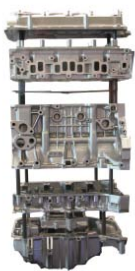
Fig. 12.4 Bloque motor de aluminio de un motor MEC
