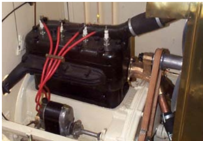
Fig. 3.5 Motor de encendido provocado de 5CV del Citroën modelo 10/20
