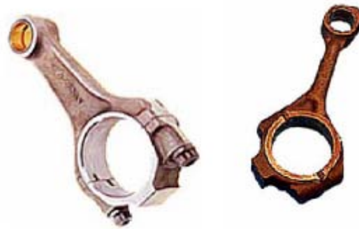
Fig. 12.66 Biela convencional y biela oblicua
