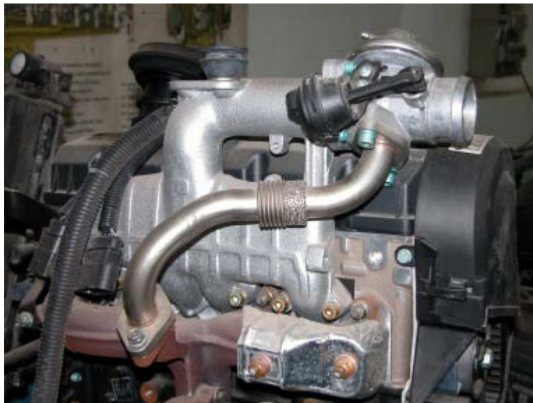
Fig. 11.14 Sistema de recirculación de gases de escape instalado en un motor MEC
