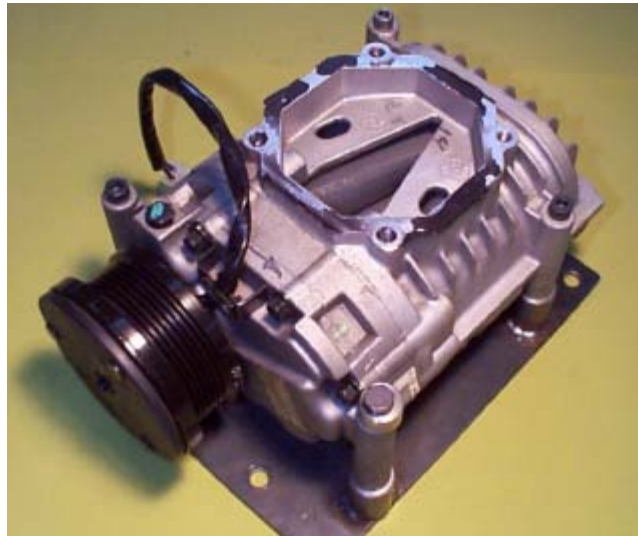
Fig. 8.4 Compressor volumétrico empleado por la firma Mercedes en sus modelos Kompressor
