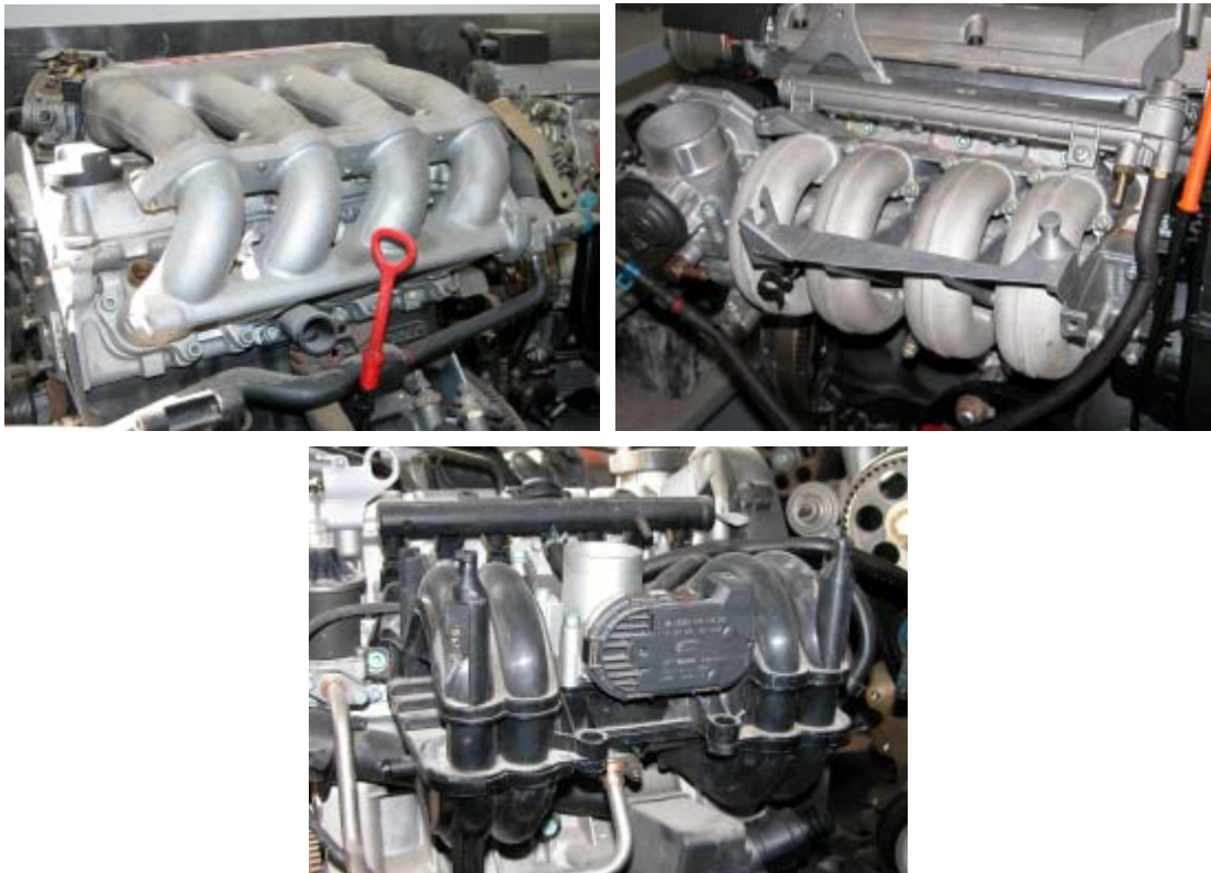
Fig. 12.31 Colectores de admisión, de aluminio y de plástico
