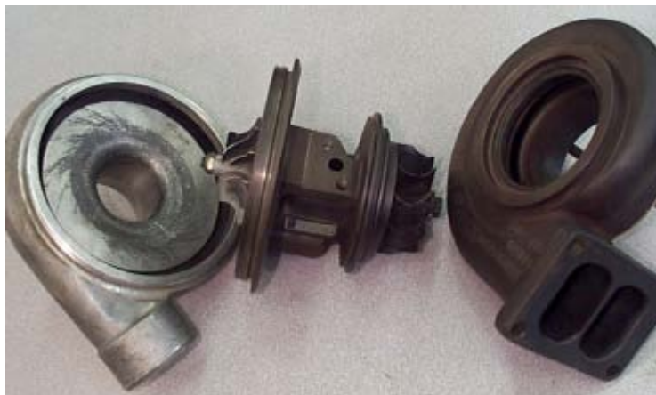
Fig. 8.9 Elementos del grupo turbocompresor
