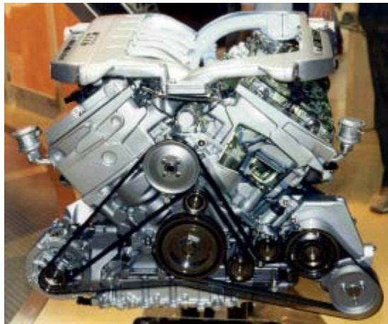
Fig. 3.25 Motor doce cilindros en W de la marca Volkswagen
