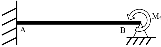
FIG. 1.2. Disposición para medir la rigidez flexional.
