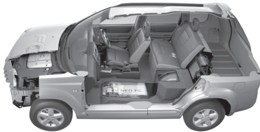
5.3/ Fotografía de un coche eléctrico equipado con una pila de combustible tipo PEMFC. Se trata del modelo Xtrail de Nissan.
