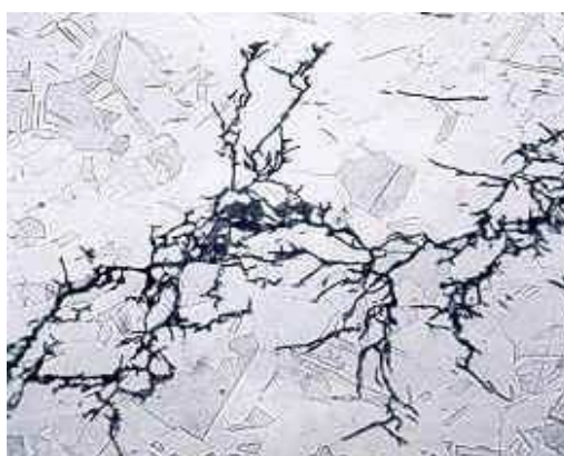
Figura B.18. Corrosión bajo tensión con desplazamiento transgranular de la grieta.
