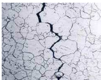
Figura B.19. Corrosión bajo tensión con desplazamiento intergranular de la grieta.
