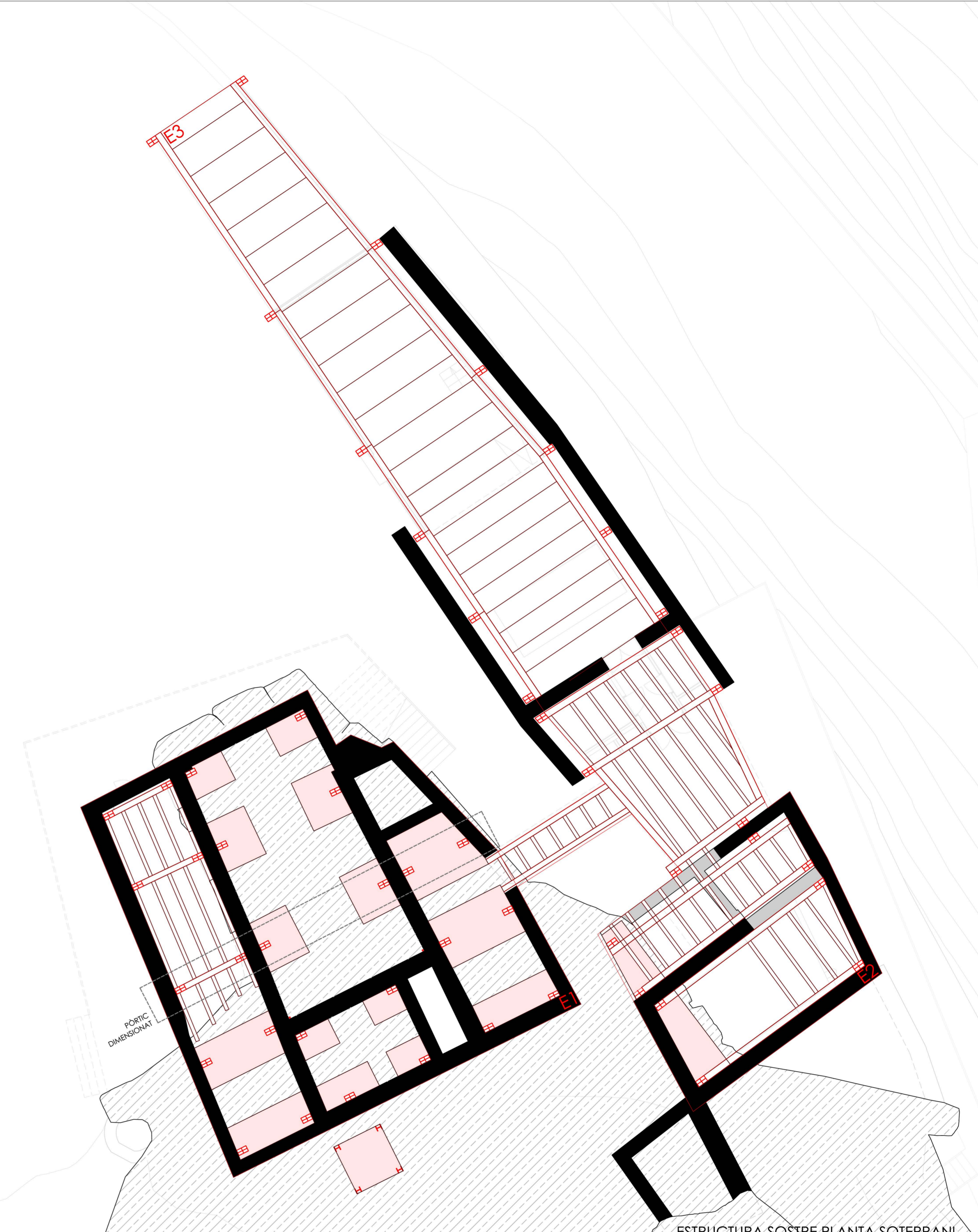
ESTRUCTURA SOSTRE PLANTA SOTERRANI
