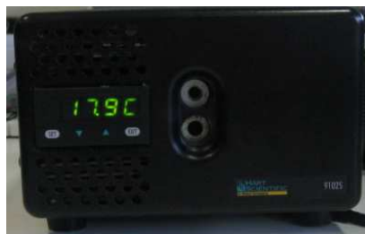
Fig 4.20 : Calibrador de temperatura 9102S Handheld Dry-Well Calibrator de Hart Scientific
