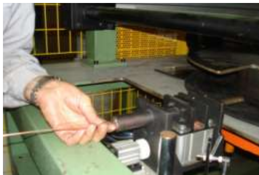
Fig. 99 Carga manual del tubo de cobre en la bobinadora.
