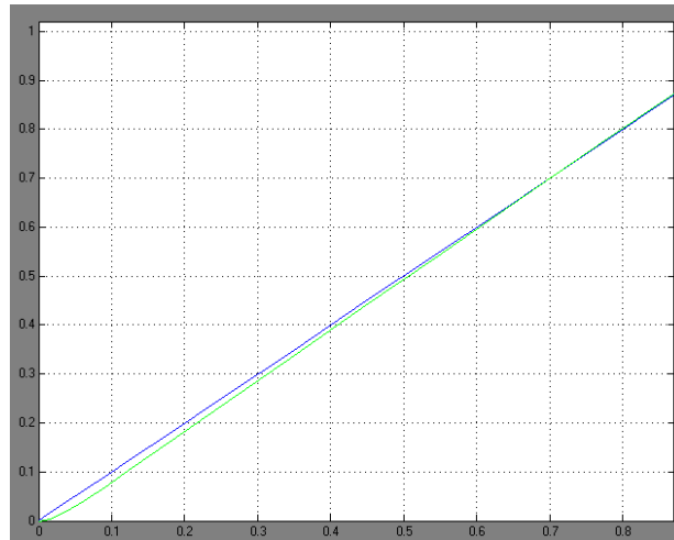
Gràfica 7 - Resposta del nou controlador a entrada rampa
