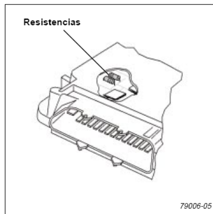
Fig. 3 Terminadores en unidad de control
