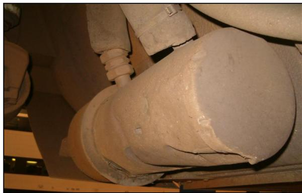
Figura 7.1. Arriba: Daños causados por impactos de balasto en los rodales del tren.
