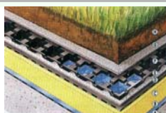
Detall coberta edificis Capa del sistema: Sapells Banyes de esparit Ajuda de drenatge Impervialització Reservori de drenatge Capa de drenatge Capa de protecció Capa de drenatge Capa de drenatge
