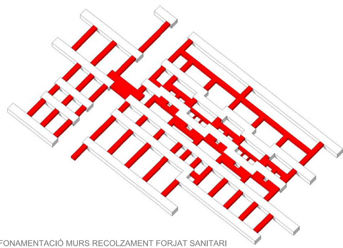
RIOSTRES I FONAMENTACIÓ MURS RECOLZAMENT FORJAT SANITARI
