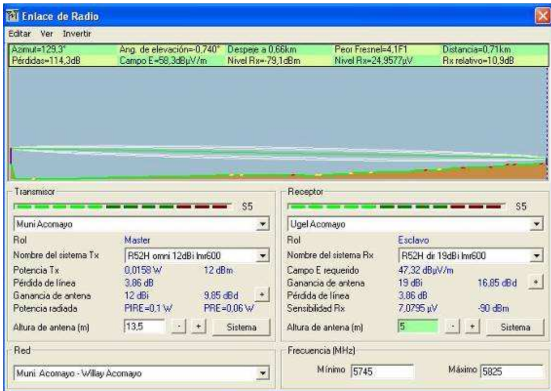
Figura 2.3: Simulación del radioenlace entre un punto final y su repetidor local
