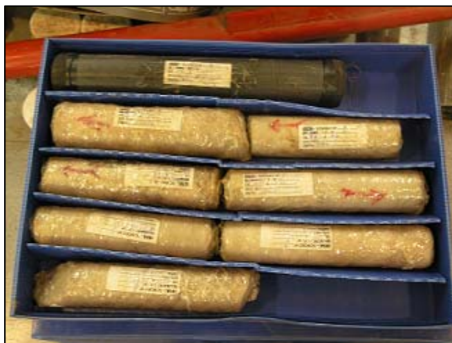
Figura 3.2.- Cajas contenedoras de los testigos recuperados en los sondeos.
