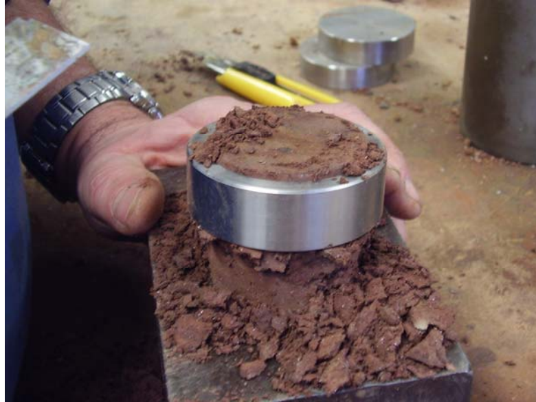
Figura 45: Imagen del proceso de preparación de la muestra del anillo del edómetro.
