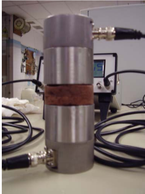
Figura 55: Disposición de la muestra en equipo de ensayo de transmisión de onda de compresión.
