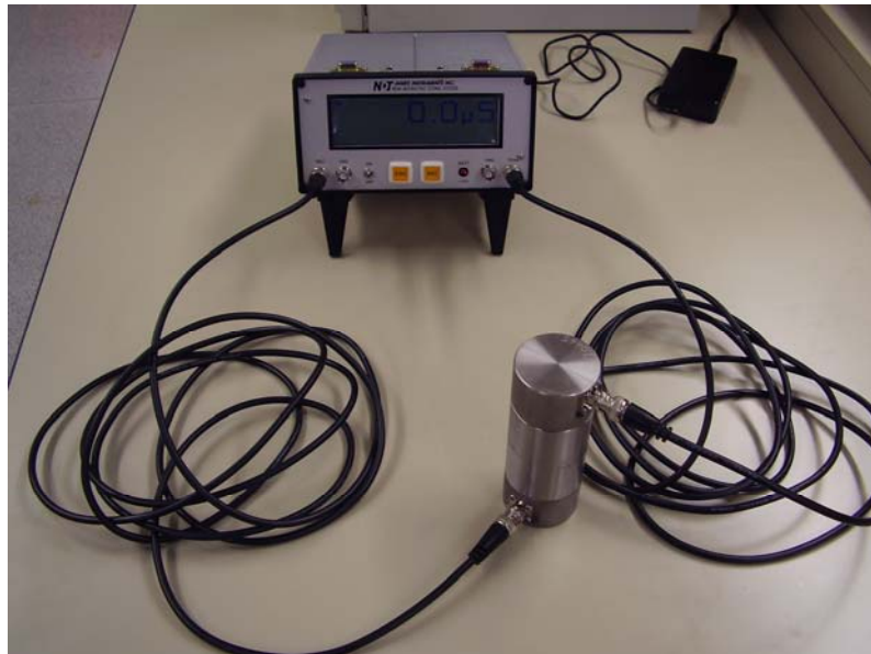
Figura 56: Equipo de ensayo de transmisión de onda de compresión.
