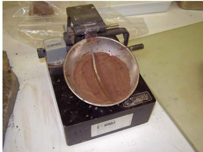
Figura 27: Cuchara de Casagrande para la determinación del límite líquido.
