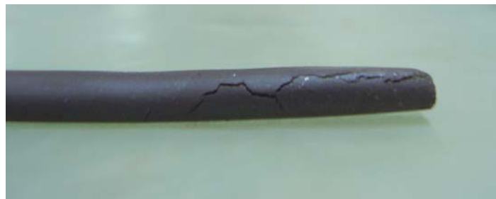
Figura 28: Fisura longitudinal en uno de los cilindros de suelo realizados en la determinación del límite plástico.
