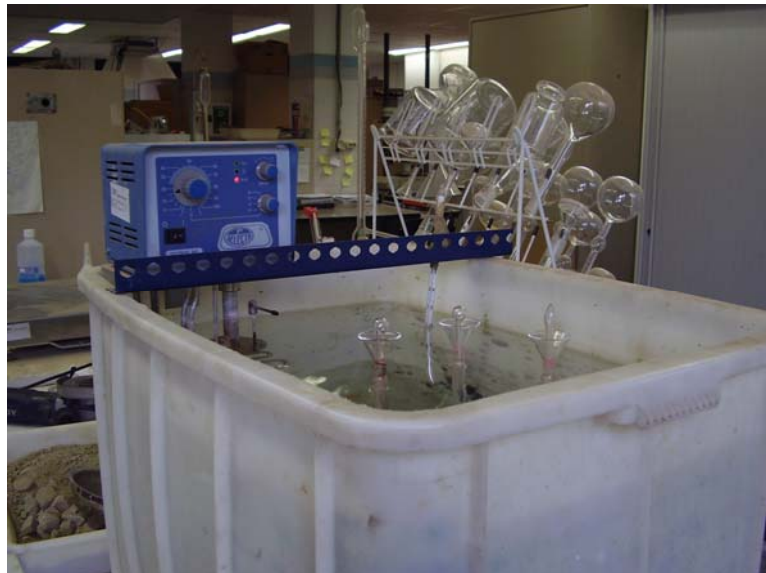
Figura 25: Recipiente para el baño de agua a temperatura constante de 25°C
