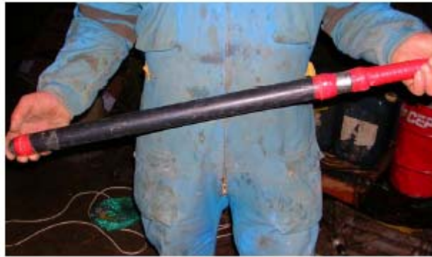
Figura 14: Sonda utilizada en los ensayos de Gamma natural.
