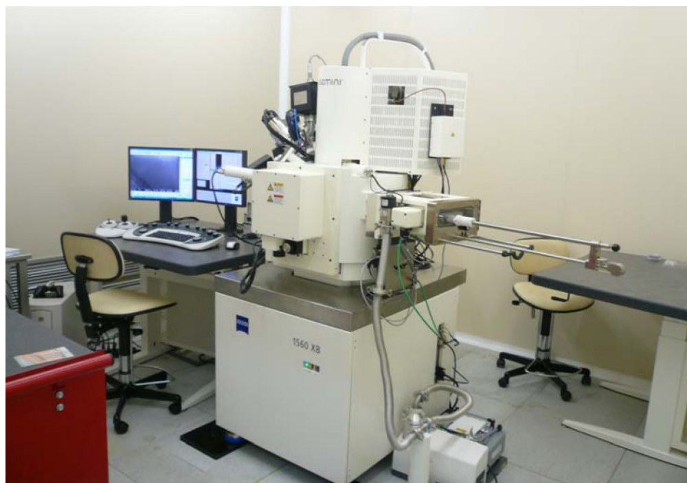
Fig. A4-1. Equipo Crossbeam 1560 XB empleado para el proyecto en la sala blanca para el FIB del CNM. Extraído de [1].
