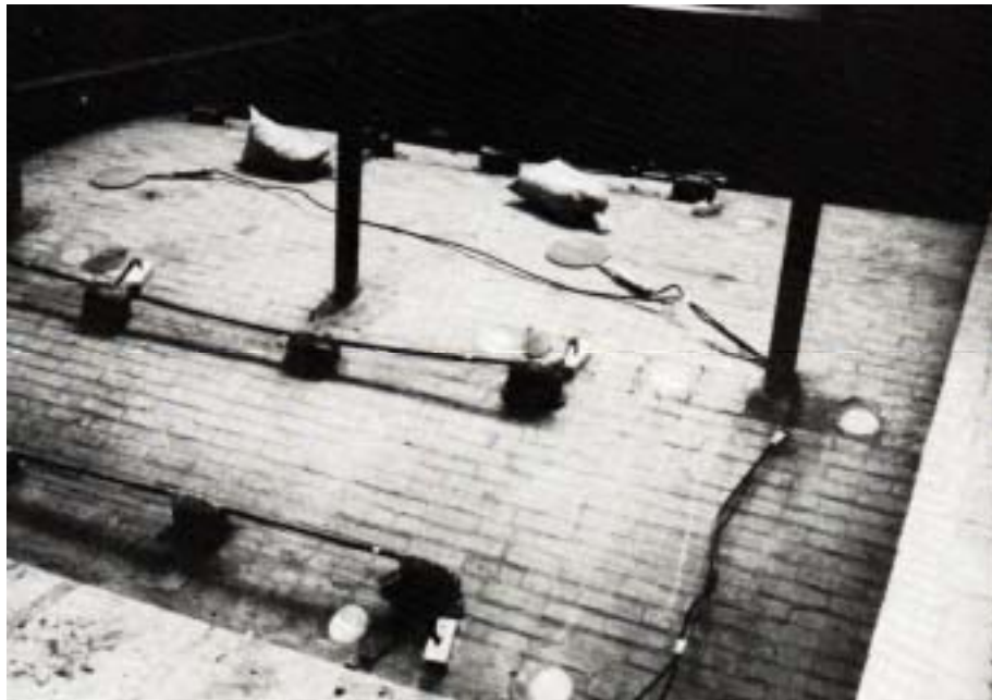
Figura 2-27. Células de carga embebidas en mortero en el interior de la bóveda del puente ensayado en el Bolton Institute[14].
