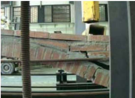
Figura 2-37. Rótula plástica bajo el punto de aplicación de carga. Vistas lados mar y montaña. Imágenes tomadas de [3].
