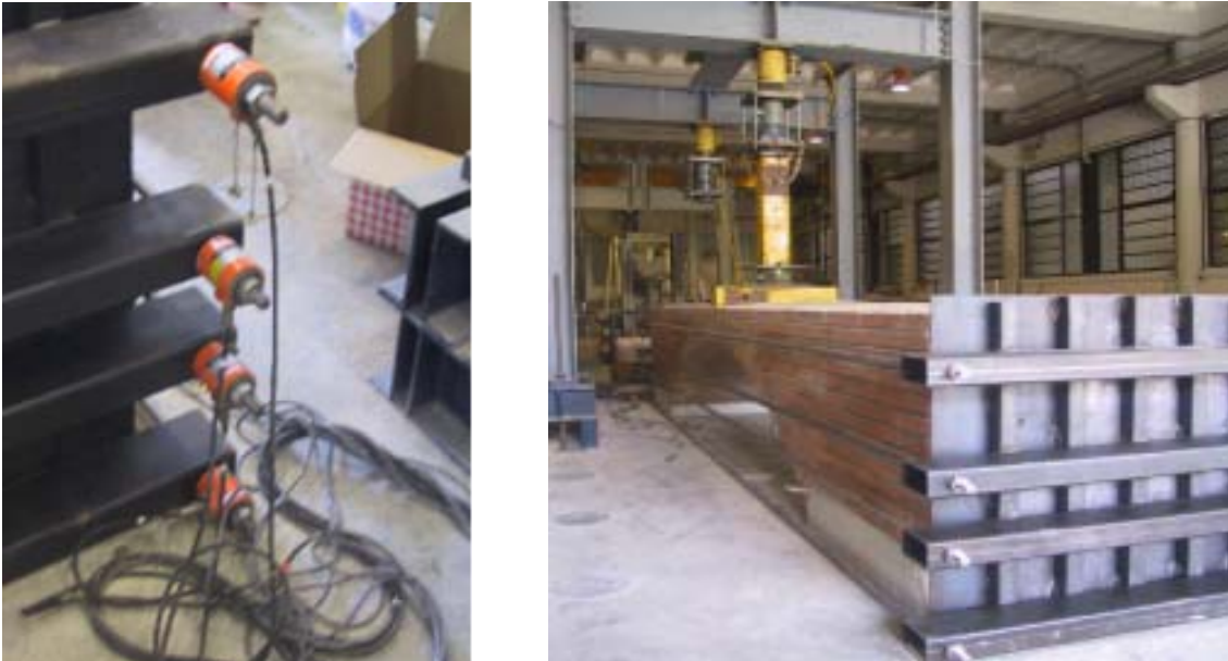
Figura 2-35. Células de carga huecas utilizadas en el ensayo (derecha). Puente listo para ensayar; se puede observar el mecanismo de aplicación de la carga. Imágenes tomadas de [5].
