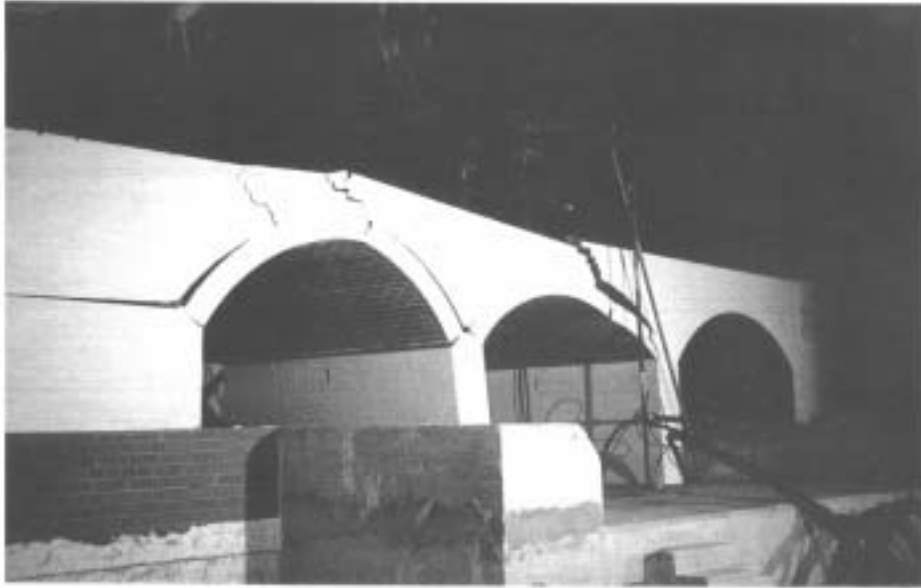
Figura 2-23. Uno de los modelos multiarco ensayados por Wagstaff y Melbourne [10].
